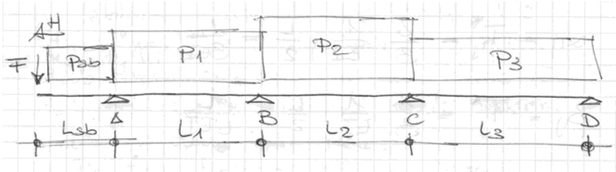
Si consideri lo SCHEMA ISOSTATICO ASSOCIATO alla trave continua che schematizza il solaio.
