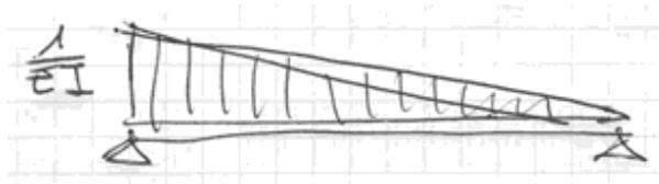
Da cui è possibile ottenere le rotazioni all'estremità (pari al taglio  $T^*$  in corrispondenza dell'appoggio dello schema ausiliario):
