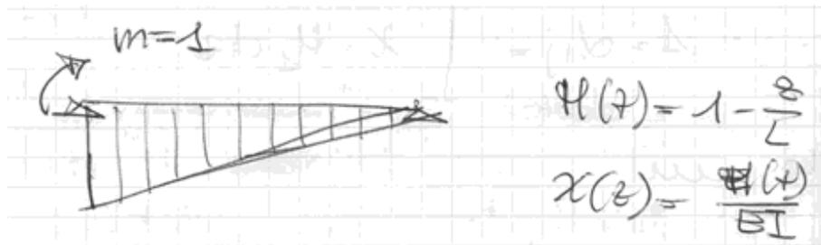
Mentre lo schema ausiliario è ottenuto caricando la trave con il diagramma delle curvature:
